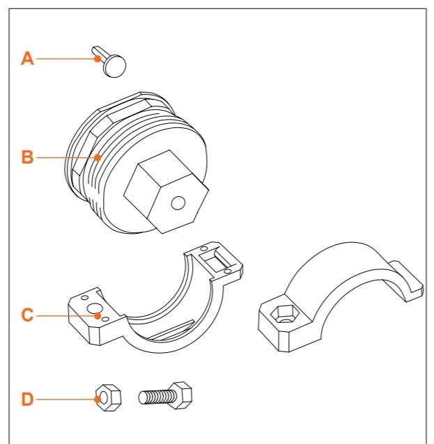
**Adapter montieren // Mount the adapter // Monter un adaptateur**
