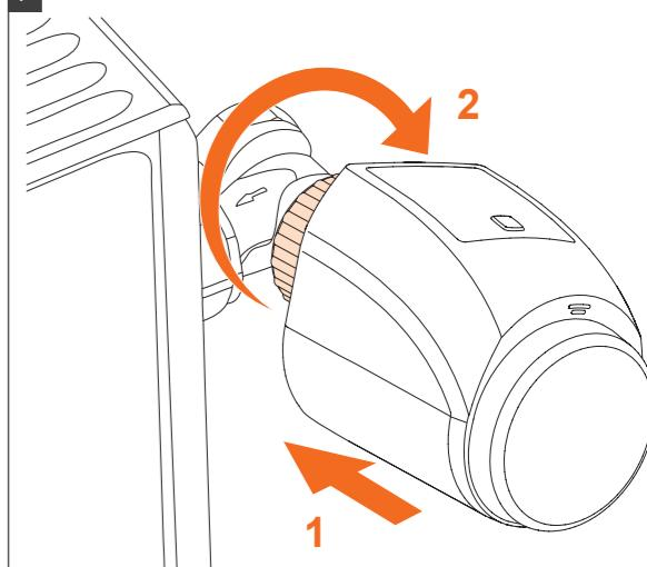
**Alten Thermostat demontieren // Remove the old thermostat // Démonter un ancien thermostat**
