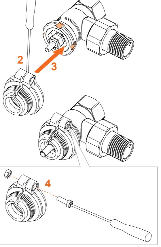
► Brechen Sie die mit dem Adapter verbundene Stößelverlängerung einfach vom Adapter ab.
