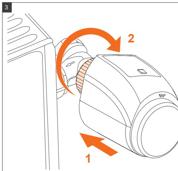
**Alten Thermostat demontieren // Remove of thermostat // Démonter un ancien thermostat**
