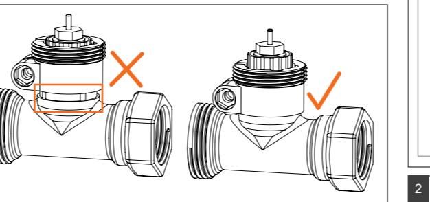
Die Adapter RA und RAV werden Zugunsten eines besseren Sitzes mit Vorspannung produziert:
