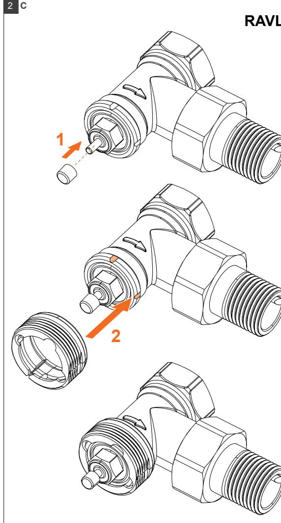
**Neuen Heizkörperthermostat montieren // Mount new radiator thermostat // Monter le thermostat de radiateur neuf**
